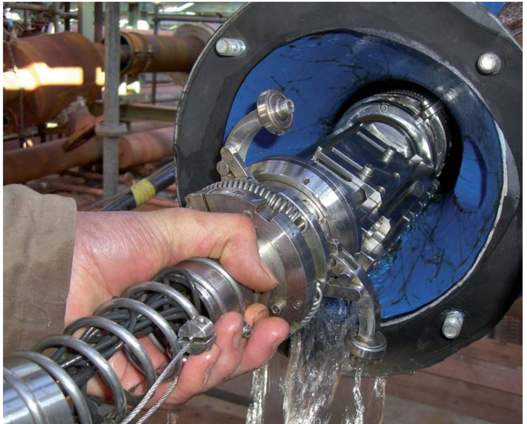
Hierfür wurde eine spezielle, lagerregelte Ultraschalleinheit aus insgesamt acht Prüfköpfen entwickelt. Die acht Prüfköpfe wurden mit einem 4 x 1 mm Linienfokus ausgestattet und so angeordnet, dass eine lückenlose Datenerfassung von +/- 16 mm im unteren Rohrleitungsbereich garantiert werden kann.
