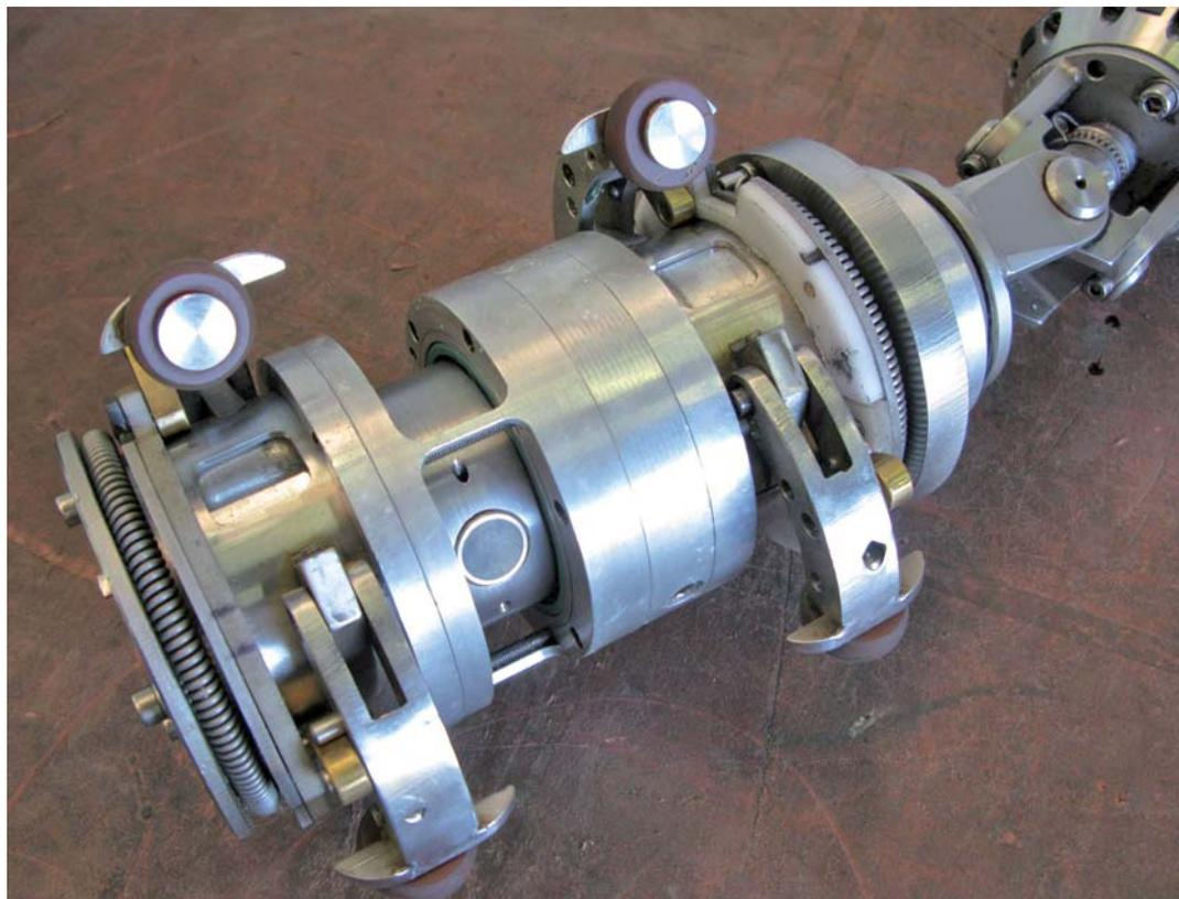
gung durch die Rohrleitung. Diese Spiralbewegung ist mit der Vorschubgeschwindigkeit so synchronisiert, dass eine vollflächige Wandstärkenprüfung realisiert wird.
