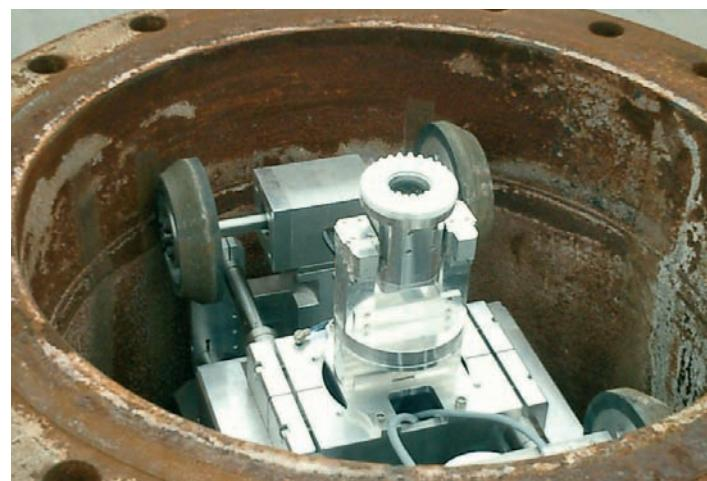
Im März 2007 feierte die LARCOM-Methode Premiere. Während des Neubaus eines konventionellen Kraftwerkes des spanischen Energieversorgers Union Fenosa in La Coruna, wurden die Dampfleitungen mithilfe des „Aquamilling“-Prozesses gereinigt und danach durch Inspektionsroboter von Inspector Systems inspiziert.
